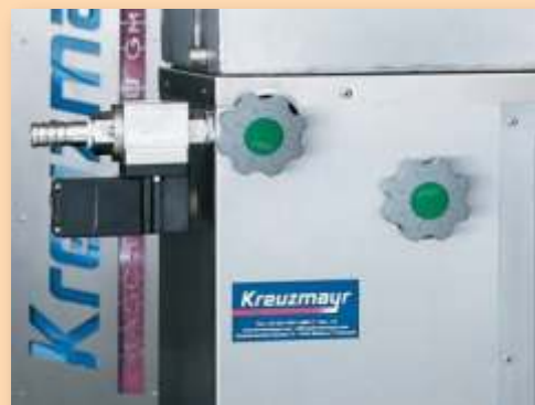
Zawór soku z regulacją przepływu i baidpasem
