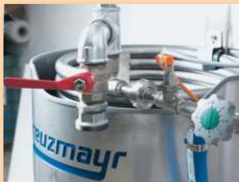
Rurowy wymiennik ciepła z przyłaczem do grzałki i regulacją przepływu
