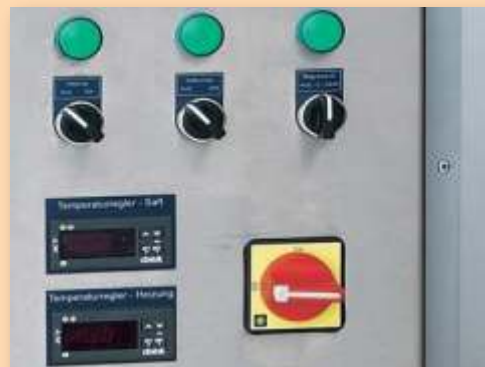
Panel obsługi z cyfrowymi wskaźnikami temperatury soku i wody
