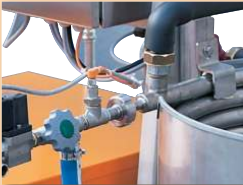
Regulacja ilości i czujnik temperatury soku
