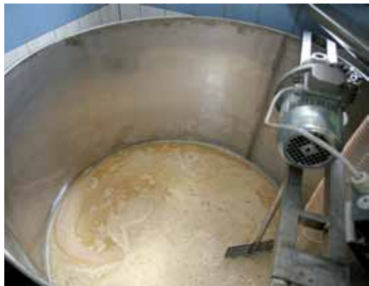
Fot. 4. Sok po odfiltrowaniu magazynowany jest w zbiorniku o pojemności 2500 l
