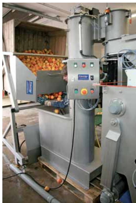
Fot. 3. Jabłka dzięki wywrotnicy są podawane bezpośrednio do kosza zasypowego, gdzie są myte
