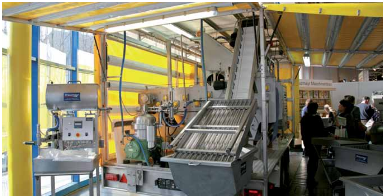
Fot. 5. Mobilna linia do produkcji soków – największa wyprodukowana przez firmę Kreuzmayr
